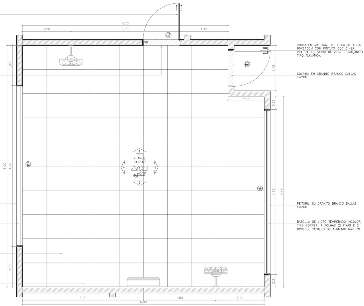
PORTA EM MADEIRA, 01 FOLHA DE ABRIR 90X210CM COM PINTURA COR CINZA PLATINA, C/ VISOR DE VIDRO E MAÇANETA TIPO ALAVANCA.
