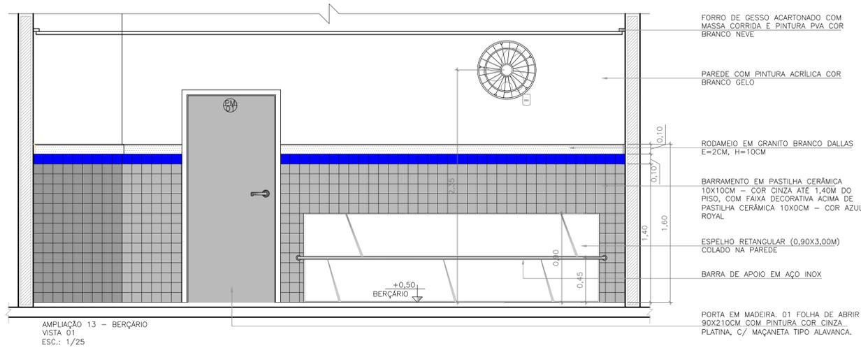
PORTA EM MADEIRA, 01 FOLHA DE ABRIR 90X210CM COM PINTURA COR CINZA PLATINA, C/ VISOR DE VIDRO E MAÇANETA TIPO ALAVANCA.
