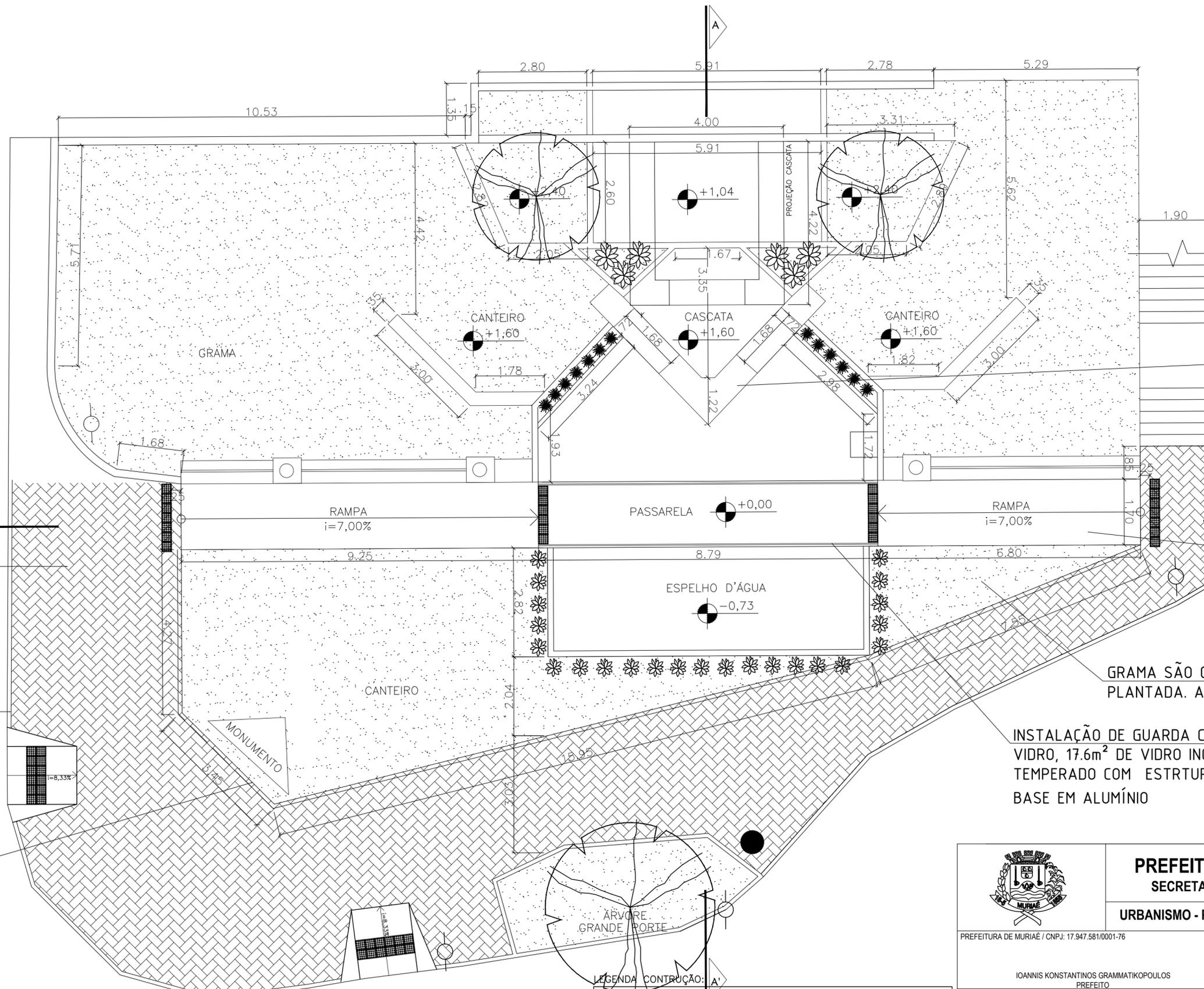
LIMPEZA COM JATO DE PRESSÃO E APLICAÇÃO DE RESINA HIDROFUGANTE NA CASCATA E DEMAIS PEÇAS DA FONTE
