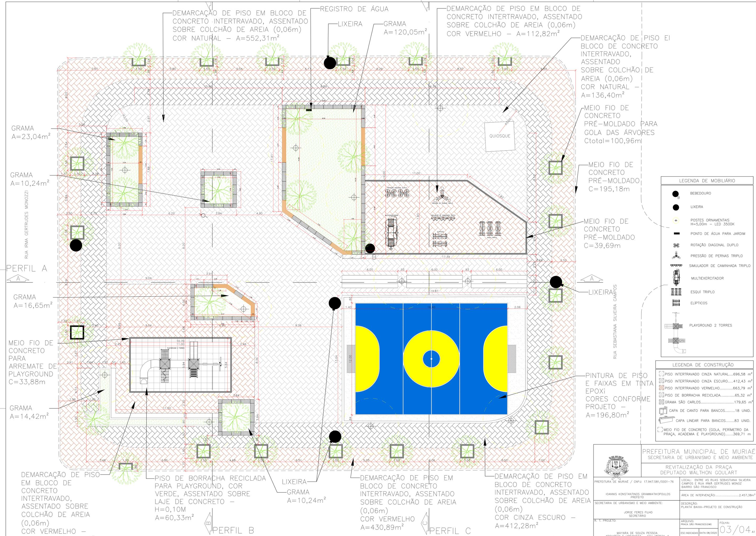
DEMARCAÇÃO DE PISO EM BLOCO DE CONCRETO INTERTRAVADO, ASSENTADO SOBRE COLCHÃO DE AREIA (0,06m) COR NATURAL - A=552,31m<sup>2</sup>
