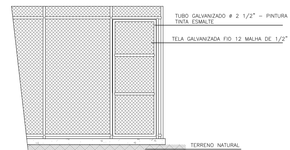
DETALHE ESQUEMÁTICO DO ALAMBRADO E PORTÃO DE ACESSO S/ESC.
