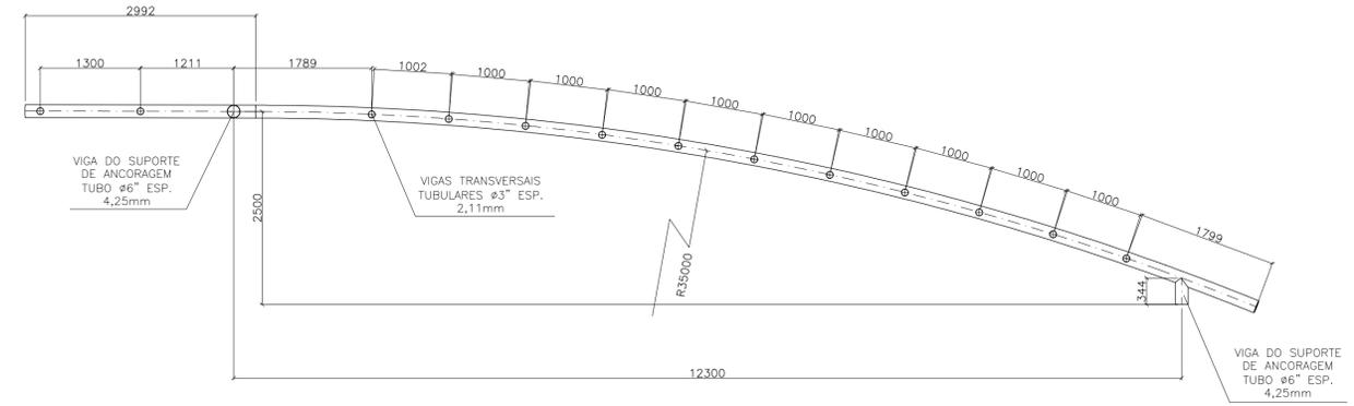
SEÇÃO A-A - VIGA LONGITUDINAL
