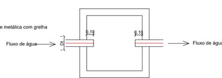
PLANTA BAIXA - CAIXA DE INSPEÇÃO
