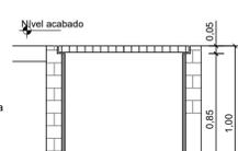
CORTE AA - CAIXA DE INSPEÇÃO
