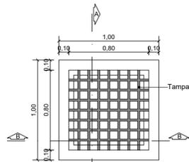
PLANTA BAIXA - CAIXA DE INSPEÇÃO
