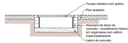
CORTE BB - CAIXA DE INSPEÇÃO
