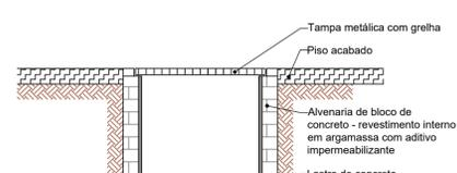
CORTE BB - CAIXA DE INSPEÇÃO
