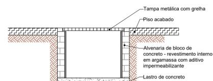
CORTE BB - CAIXA DE INSPEÇÃO
