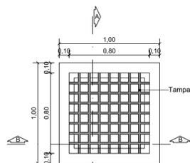
PLANTA BAIXA - CAIXA DE INSPEÇÃO
