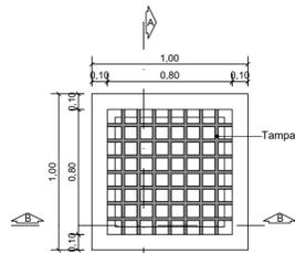
PLANTA BAIXA - CAIXA DE INSPEÇÃO
