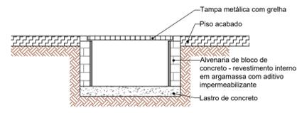
CORTE BB - CAIXA DE INSPEÇÃO
