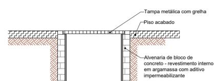
CORTE BB - CAIXA DE INSPEÇÃO
