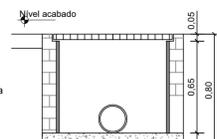
CORTE AA - CAIXA DE INSPEÇÃO
