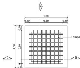
PLANTA BAIXA - CAIXA DE INSPEÇÃO
