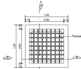
PLANTA BAIXA - CAIXA DE INSPEÇÃO
