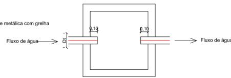
PLANTA BAIXA - CAIXA DE INSPEÇÃO
