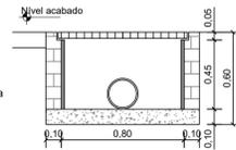
CORTE AA - CAIXA DE INSPEÇÃO
