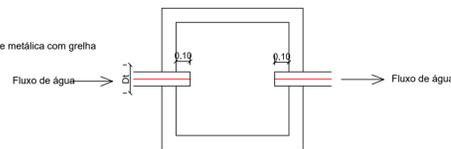
PLANTA BAIXA - CAIXA DE INSPEÇÃO
