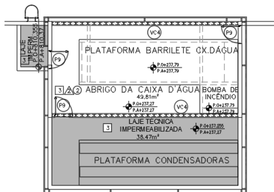
Figura 6 - Planta baixa do abrigo da caixa d'água
