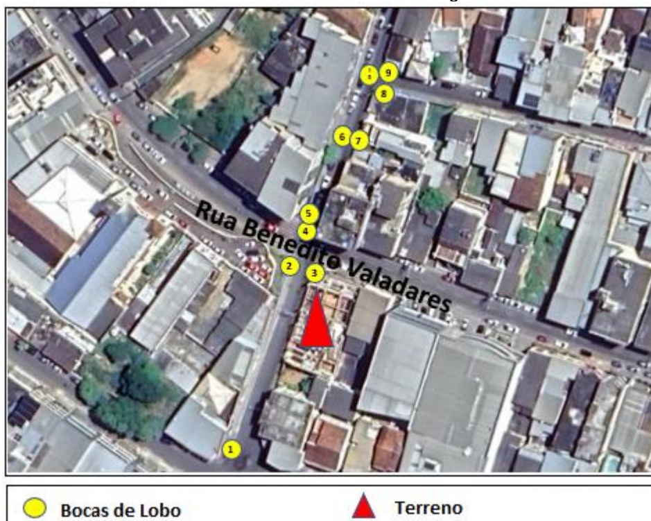
FIGURA 10 – Sistema de Drenagem
