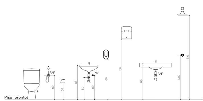
ALTURAS DE INSTALAÇÃO ESCALA 1:25
