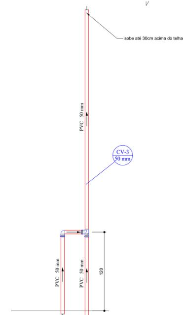
**DETALHE S3- LIGAÇÃO COLUNA VENTILAÇÃO - VERTICAL**
