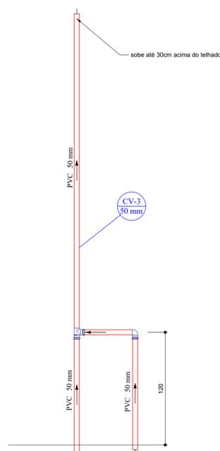
**DETALHE S1- LIGAÇÃO COLUNA VENTILAÇÃO - VERTICAL**
