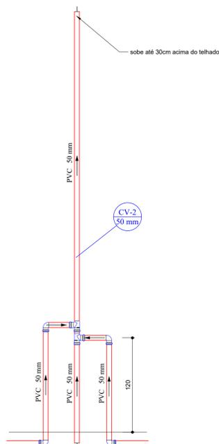
**DETALHE S2- LIGAÇÃO COLUNA VENTILAÇÃO - VERTICAL**
