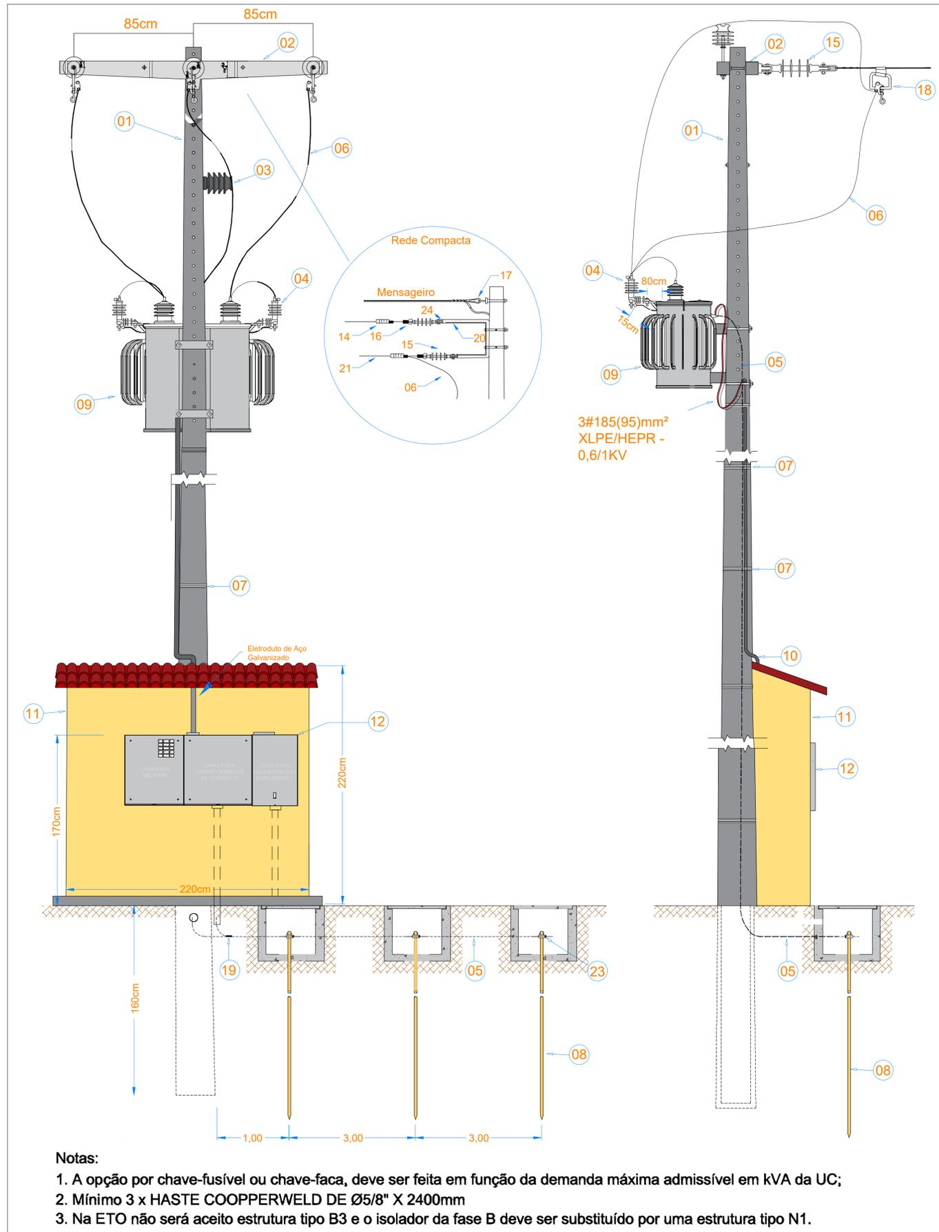
DESENHO CONSTRUTIVO SUBESTAÇÃO AÉREA 112.5KVA - PADRÃO ENERGISA.
