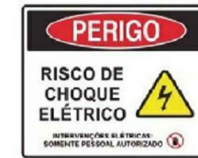
Exemplo de sinalização para quadro ou painel de comando e potência
