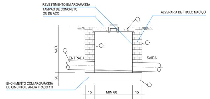
CORTE AA\_CAIXA DE INSPEÇÃO DE ESGOTO S/ESCALA
