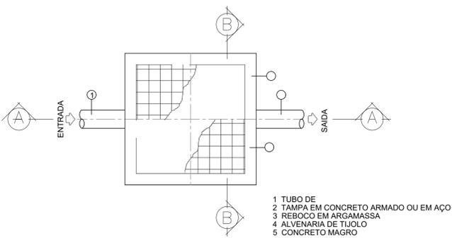
DETALHE - CAIXA DE INSPEÇÃO DE ESGOTO S/ESCALA
