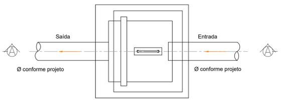
DETALHE - CAIXA DE INSPEÇÃO DE ESGOTO SIFONADA S/ESCALA
