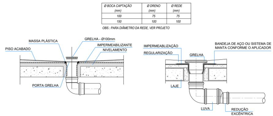
DETALHE - INSTALAÇÃO DE RALO MONTADO TIPO GRELHA S/ESCALA
