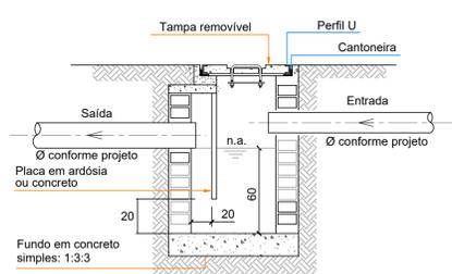
CORTE AA\_CAIXA DE INSPEÇÃO DE ESGOTO SIFONADA S/ESCALA
