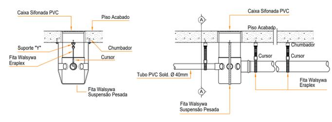
DETALHE - LIGAÇÃO FIXAÇÃO CAIXA SIFONADA S/ESCALA
