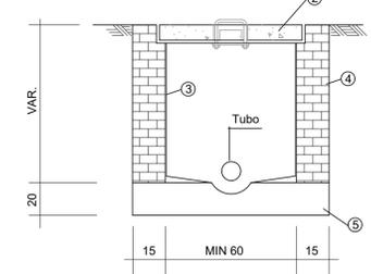
CORTE BB\_CAIXA DE INSPEÇÃO DE ESGOTO S/ESCALA
