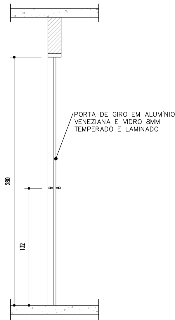
CORTE DETALHE ESQUADRIA PA3 ESCALA.....1/25
