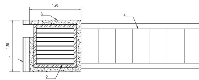
DRENAGEM - CAIXA DE CAPTAÇÃO ESPECIAL 1,2x1,2x0,30
