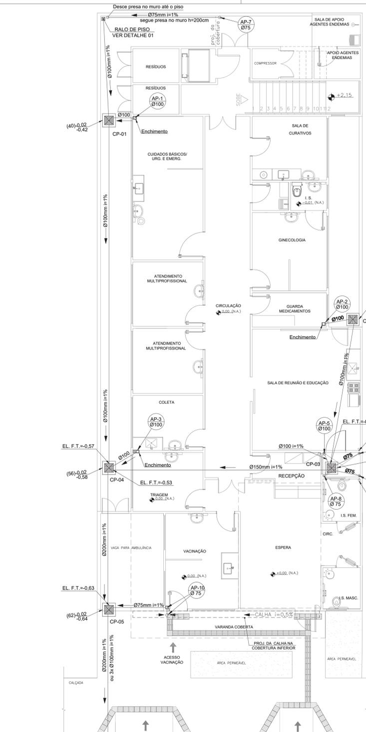
**PLANTA 1º PAVIMENTO - DRENAGEM PLUVIAL**
