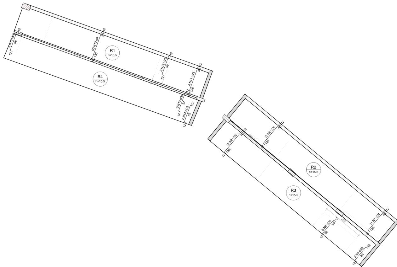
Armação negativa das lajes do pavimento Terreo (Eixo Y)
