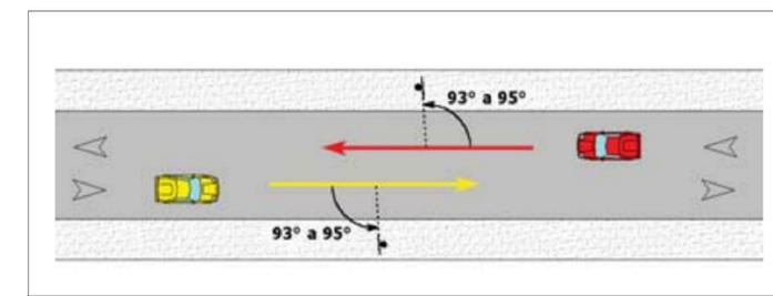
POSICIONAMENTO DA SINALIZAÇÃO VERTICAL DE REGULAMENTAÇÃO R-19 ESC: SEM ESCALA
