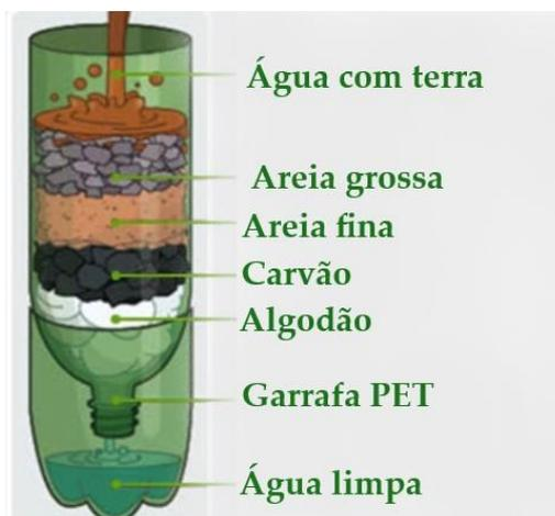
Figura 72: Esquema de montagem do filtro de água caseiro.
