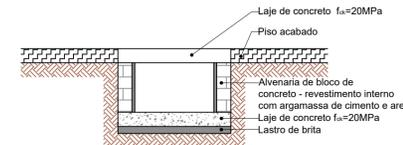
CORTE BB - CAIXA DE INSPEÇÃO
