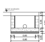
CORTE AA - CAIXA DE INSPEÇÃO
