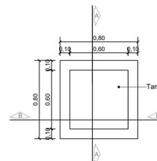
PLANTA BAIXA - CAIXA DE INSPEÇÃO
